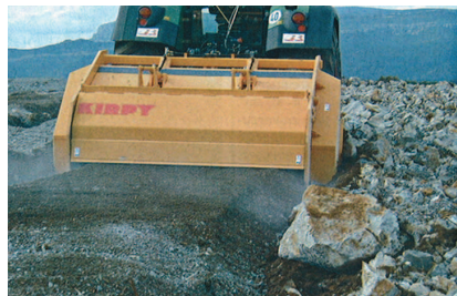
Figure 7. Broyeur de pierre mobile
