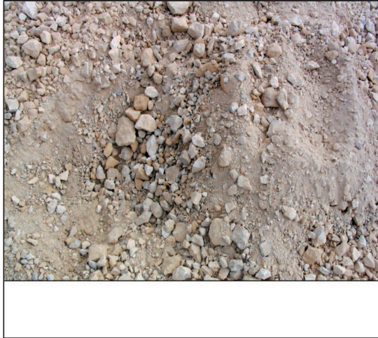
Figure 13. Matériau broyé - 3 passes
